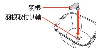
羽根取付け軸と羽根の穴の形を合わせ、奥まで押し込みます。
