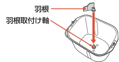
羽根取付け軸と羽根の穴の形を合わせ、奥まで押し込みます。羽根が浮いているとパンができません。
