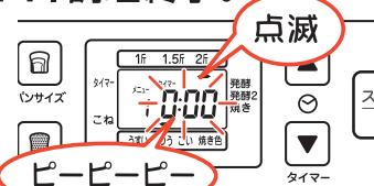
パンが出き上ると「ピーピーピー」と音がして、表示窓に**0:00**が点滅表示されます。
