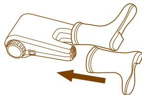
スタンドをたたみ、製品を横向きにして床に置き、長靴を吹出口にセットします。
