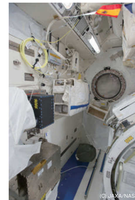
「FROST」は、無重力の「きぼう」船内で使われ、約12Lの容積の庫内温度を室温-70℃まで0.1℃単位で設定できます。
