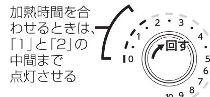
加熱中は点滅で残り時間を表示します。
