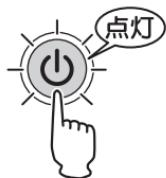
電源プラグをコンセントに差し込んで、タッチスイッチを操作します。
