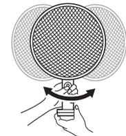
風向きを左・右に変えたいときは、クリップを持ちながらネック部を左・右に回転させて調整してください。
