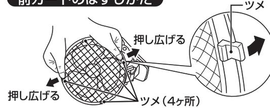
図のように両手でツメを押し広げるようにすると前ガードがはずれます。
