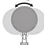
ネックの角度を左右に変えたいときは、クリップを持ちながらネック部を左右に動かして調整してください。
