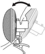
風向きを上・下に変えたいときは、ネック部を持ちながら、モーターカバー部を上・下に動かして調整してください。
