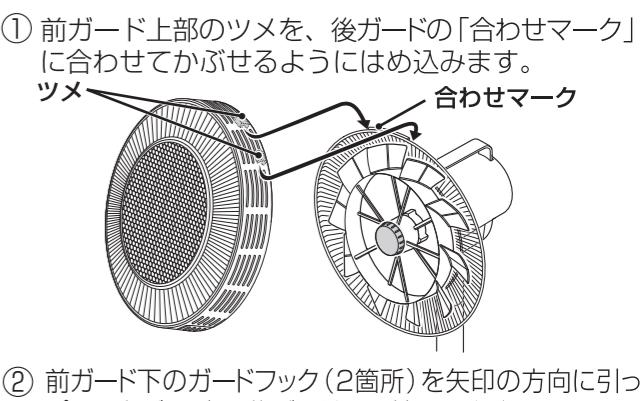
② 前ガード下のガードフック(2箇所)を矢印の方向に引っ張って広げながら、後ガードに取付けてください。
