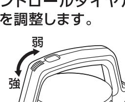
6. パワーコントロールダイヤルを操作して吸込力を調整します。
