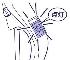
充電中は電源スイッチ部にある充電表示ランプが点灯しつづけます。充電完了後自動的に消灯します。(充電時間：約5時間)
