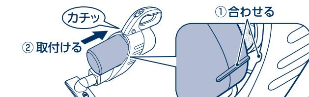
本体の溝とダストケースの突起部を合わせて、本体を手で押さえながらダストケース全体を押しつけるように「カチッ」と音がするまで確実に取付けてください。
