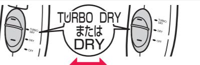
風量切替スイッチを「TURBO DRY」または「DRY」に合わせます。
