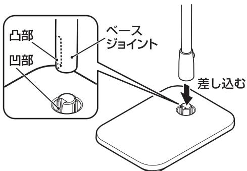
〈はずしかた〉 ベース底面のツメを図のように押しながら抜く。
