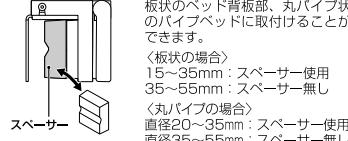
クランププレートを可動し、ベッドに取付けます。
