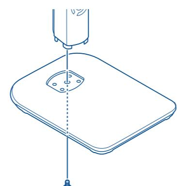
③ ①ではずしたベース取付ネジを締付けます。
