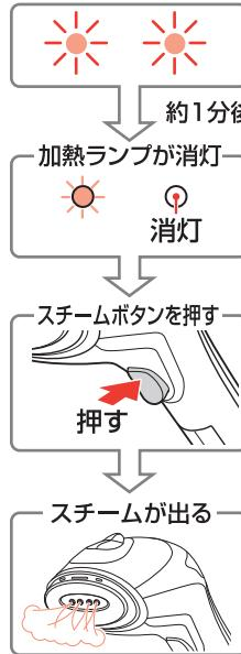
約1分でヒーターが温まって加熱ランプが消灯します。スチームボタンを押すと、スチームが出ます。使いはじめは加熱ランプが消灯してからスチームボタンを押してください。ヒーターが温まる前にスチームボタンを押すと水ができます。加熱ランプは温度調整を自動的にするため、点灯→消灯を繰り返します。
