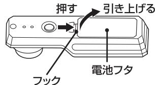
電池フタのフックを押しながら、電池フタを引き上げます。
