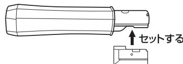
タンクの吸水口を上にして、本体にセットします。タンクは本体を水平にしてはめます。
