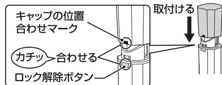
「キャップの位置合わせマーク」印とロック解除ボタンの位置を合わせます。「カチッ」というまで取付けます。
