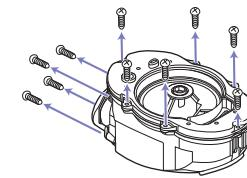
⑦ モーターカバーをはずし、モーターを少し引き出すと下本体部がはずれます。
