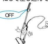
モーターの回転の反動で本体が倒れてけがや、床面を傷つける原因になります。
