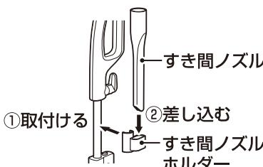
すき間ノズルホルダーをパイプに取付け、すき間ノズルを差し込みます。
