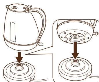
電源ベース接続部と本体接続部を合わせてセットします。
