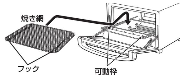
焼き網のフックを下向きにして、可動枠の内側にくるようにセットしてください。
