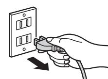
使用後は、温度調節レバーを左端に戻して、電源スイッチを「切」にしてからコンセントから電源プラグを抜いてください。
